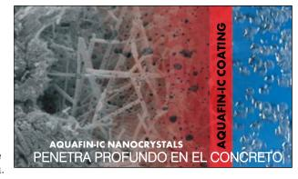
y la reaccion continuara dandose en el momento que este presente el agua por toda la vida de la estructura de concreto convirtiendo el AQUAFIN-IC una solucion realmente permanente e integral. Los nano-cristales del AQUAFIN-IC creceran dentro y a lo largo de grietas estaticas finas sellandolas y previniendo futuras filtraciones de agua.
